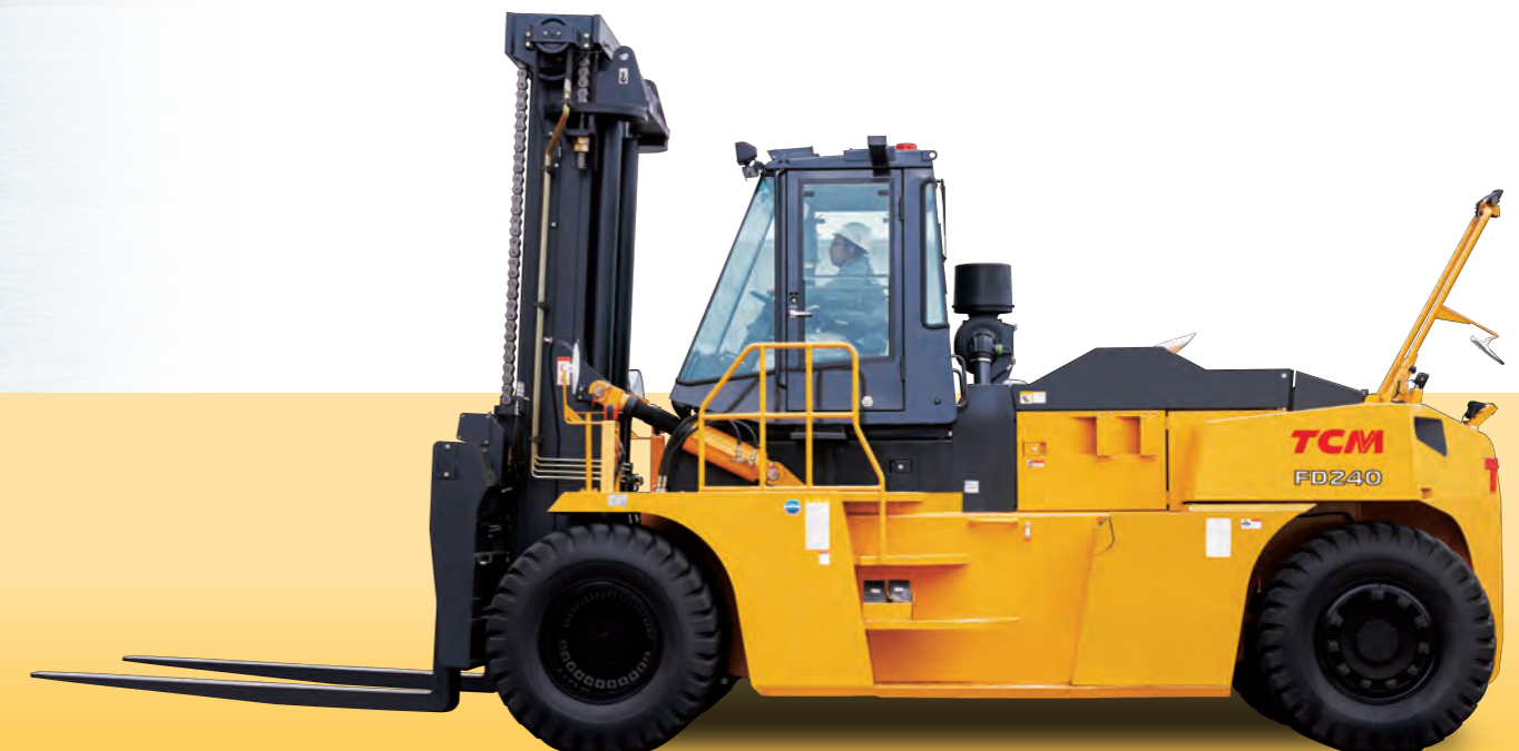
大型フォークリフト FD Series 24 ton FD240-5 2400kg / 1250mm
